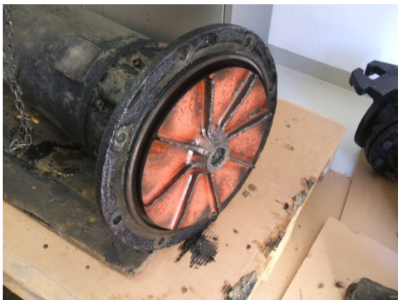
Abb. 7: altes Laufrad der Pumpe
